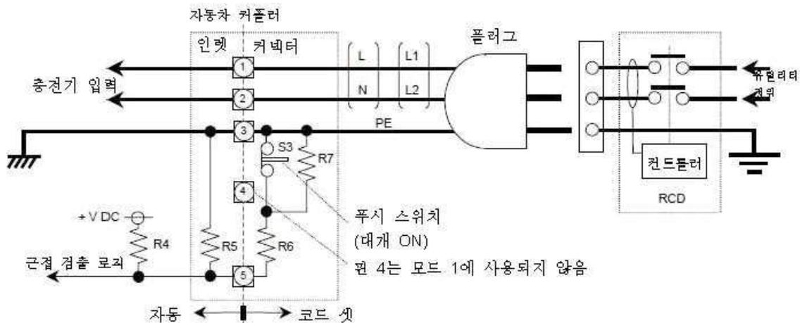
그림 B.1 - 기본 단상 자동차 커플러를 사용한 모드 1의 B형
