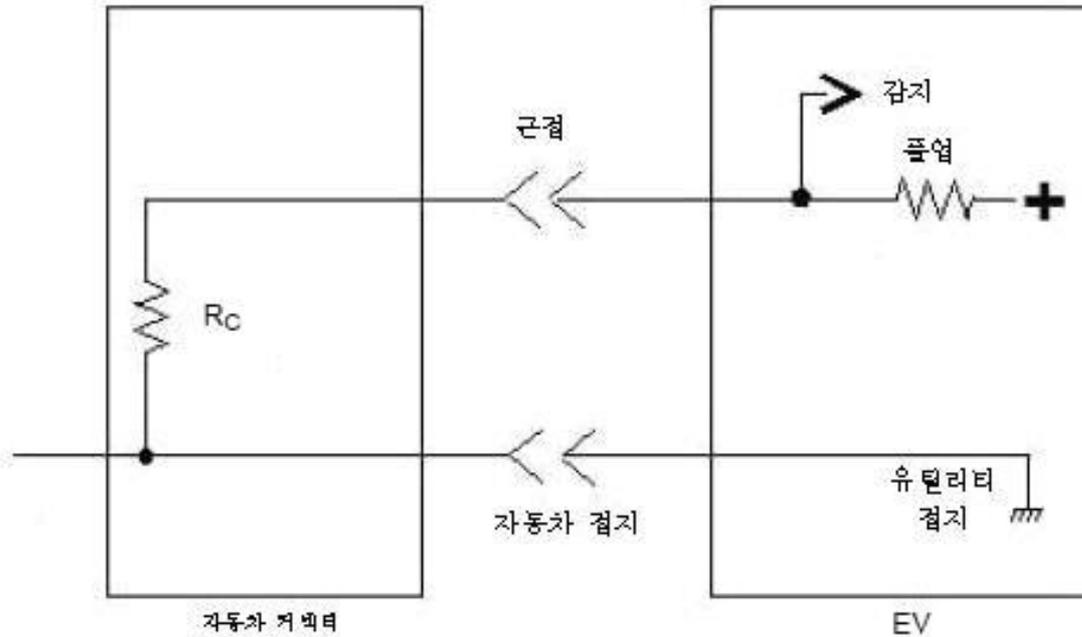
그림 B.6 - 케이블 어셈블리의 전류 용량 부호화에 대한 다이어그램
